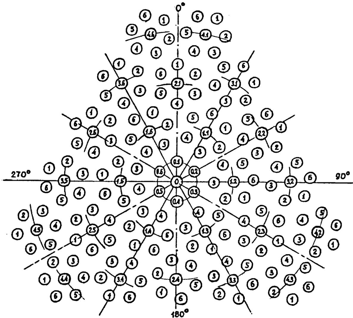
**FIG. 3. DISTRIBUTION OF THE LATTICE FRAME AND RETROREFLECTORS OVER A ZONE**
