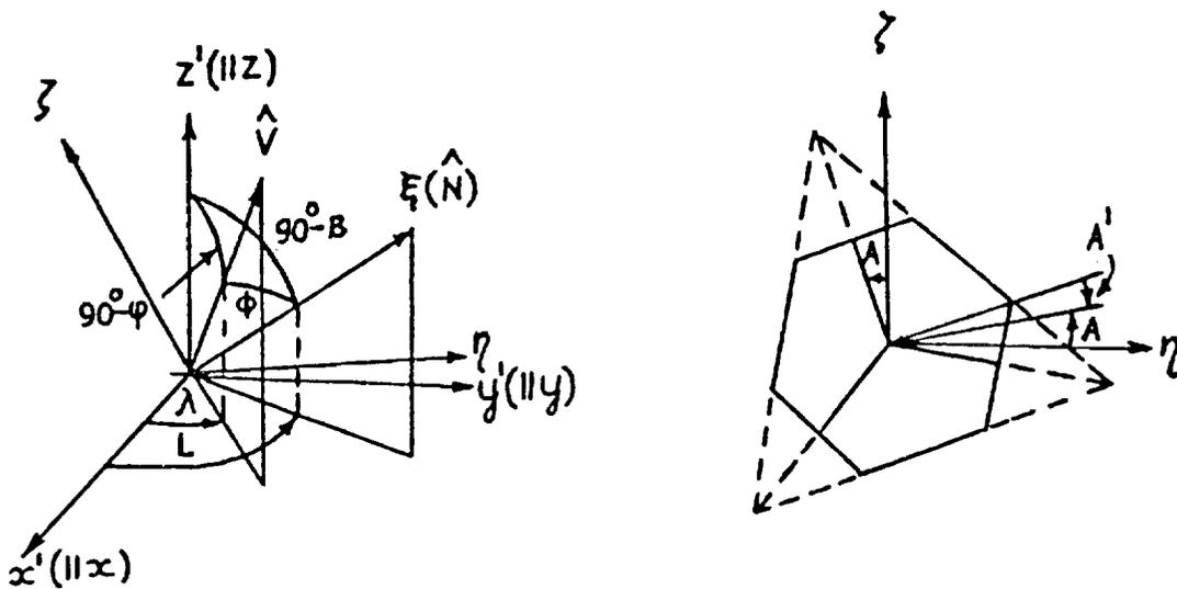
FIG. 8. COORDINATE SYSTEMS FOR RETROREFLECTOR POSITION AND ORIENTATION
